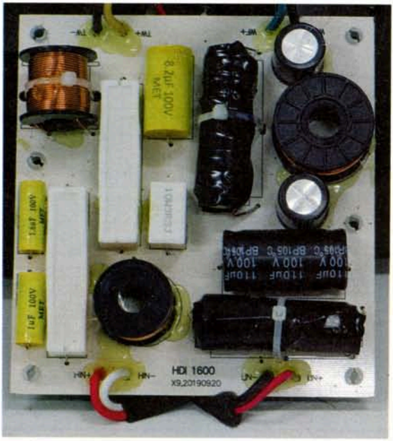
Condensatori bipolarizzati ed induttanze avvolte su lamierini di ferro caratterizzano la cella passa-basso del woofer mentre la sezione passa-alto del tweeter mostra condensatori in poliestere ed induttanze avvolte in aria. La frequenza di incrocio è poco inferiore ai 2.000 Hz.
