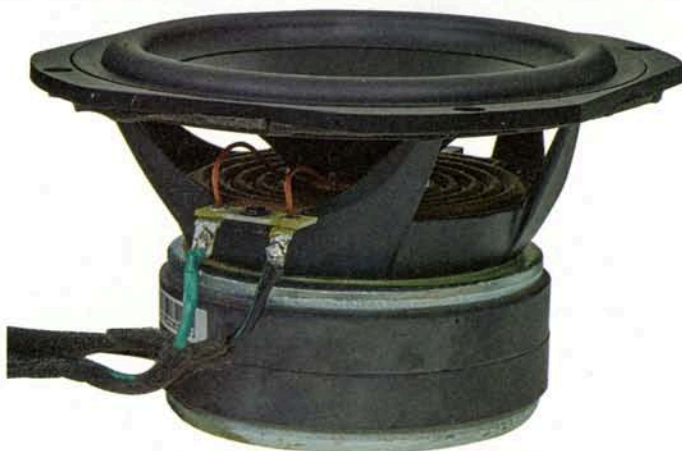
Il trasduttore per le note basse, dal diametro della membrana di circa 130 mm, ha mostrato alla misura un Qts mediamente elevato nonostante il doppio anello di ferrite nel complesso magnetico. La membrana è realizzata in alluminio.
