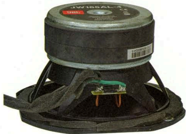
Il trasduttore per le note basse, dal diametro della membrana di circa 130 mm, ha mostrato alla misura un Qts mediamente elevato nonostante il doppio anello di ferrite nel complesso magnetico. La membrana è realizzata in alluminio.
